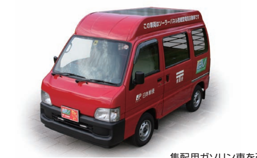
集配用ガソリン車を改造した電気自動車
