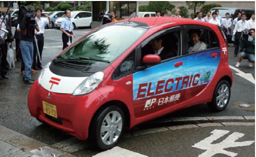
集配用ガソリン車を改造した電気自動車
