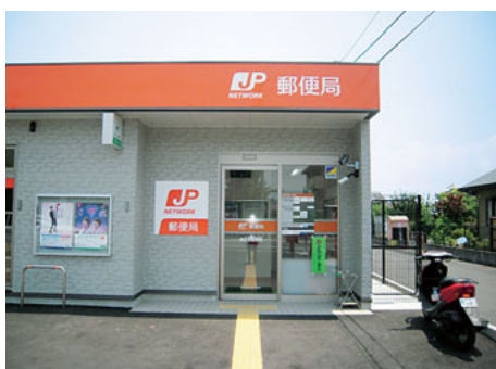
点字ブロック
