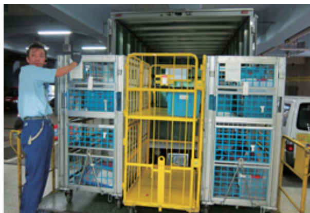
ロールパレットの積卸し作業(平成23年、郵便事業(株)芝支店) 手紙・はがきは、ロールパレットケースに納入した後、アルミ製などのロールパレットに搭載して運送します。ゆうパックは、1個ずつロールパレットに直接搭載して運送します。
